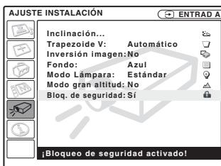
**5** Apague la alimentación principal y desconecte el cable de alimentación de CA. El bloqueo de seguridad tiene efecto después de haber activado el bloqueo de seguridad. Cuando se vuelve a encender la alimentación, se muestra la pantalla para escribir la contraseña.
